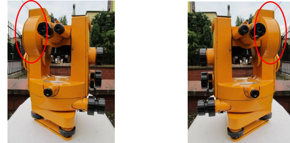
I položaj durbina (krug levo – KL)
